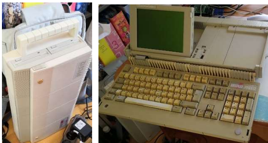
Erster PPC 512 (englisch) ohne Zweiter PPC 512 (deutsch) mit Abschirmblechen, etwas vergilbt
