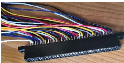
64 PIN-Stecker (62 werden genutzt, PIN 32/64 leer)
