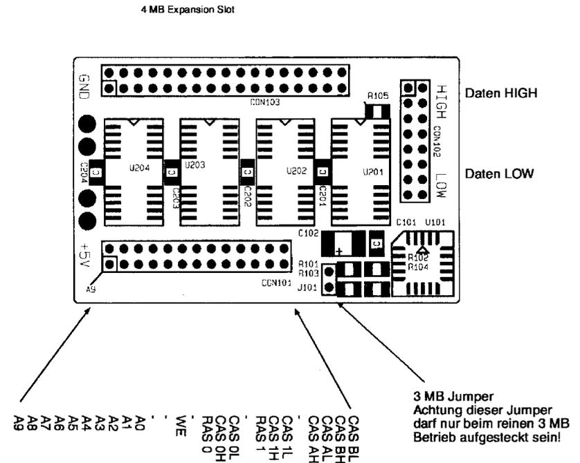
Die IMEX II wird fertig bestückt ausgeliefert. Zur Vollständigen Dokumentation und zur Beschreibung der Pinbelegung ist hier der komplette Bestückungsplan abgebildet. Die Steuerleitungen haben in der Abbildung die gleiche Reihenfolge, wie das mitgelieferte Flachbandkabel.
